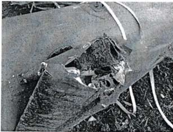
Слика 37. Поломљен десни стабилизатор
