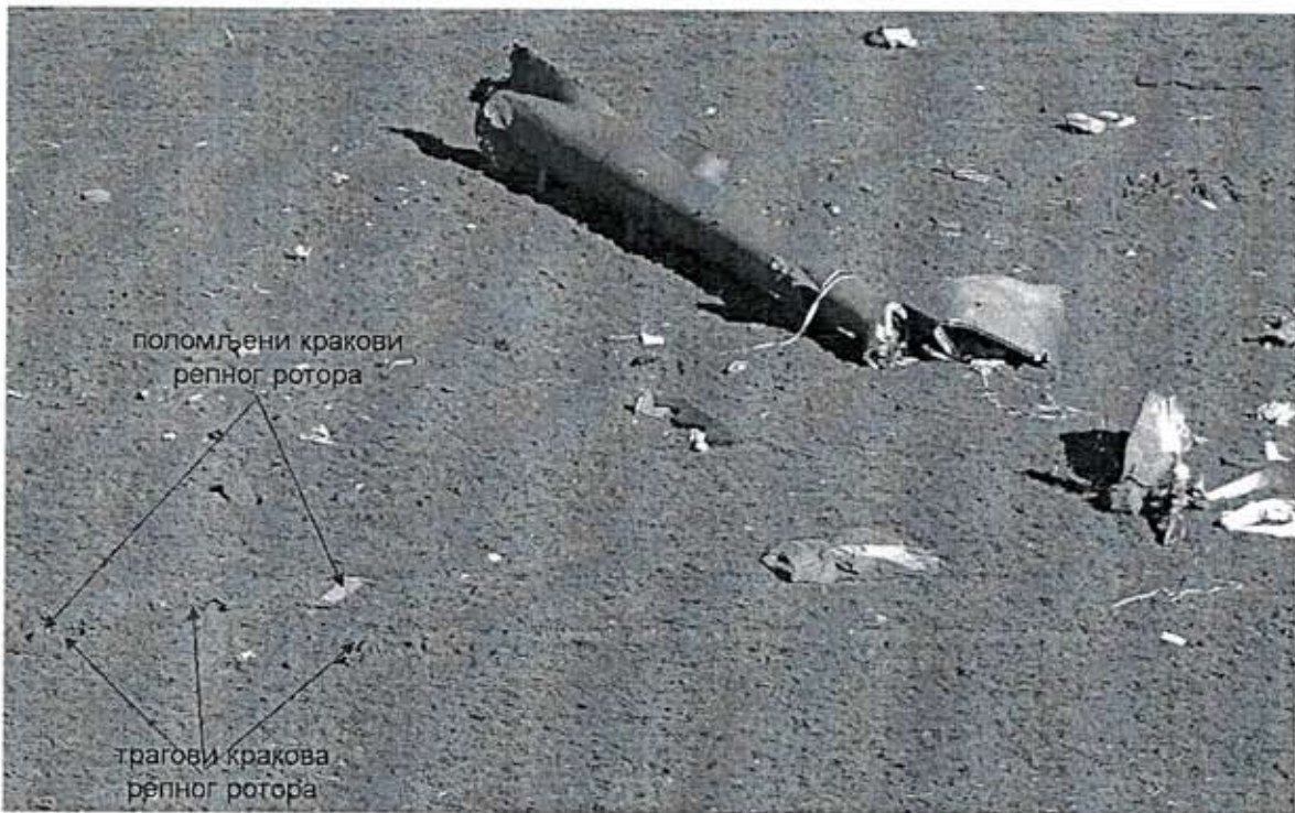
Слика 31. Распоред трагова и поломљених кракова репног ротора
